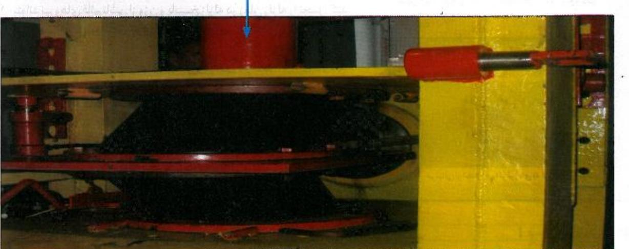
شماره ۷- آزمایش ۲ جداگر لرزه‌ای از پروره‌زاوه تربت ( محل آزمایش: کشور امیرستان )
